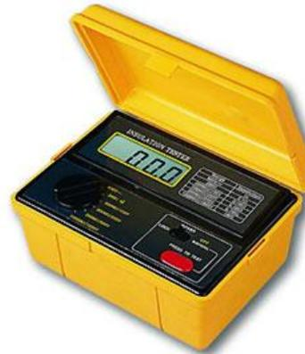
Para a medição de uma resistência, a resistência deve estar desligado da fonte de alimentação.
