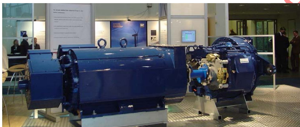
Figura 18 - Gerador conectado a caixa de engrenagens (vista a direita)
