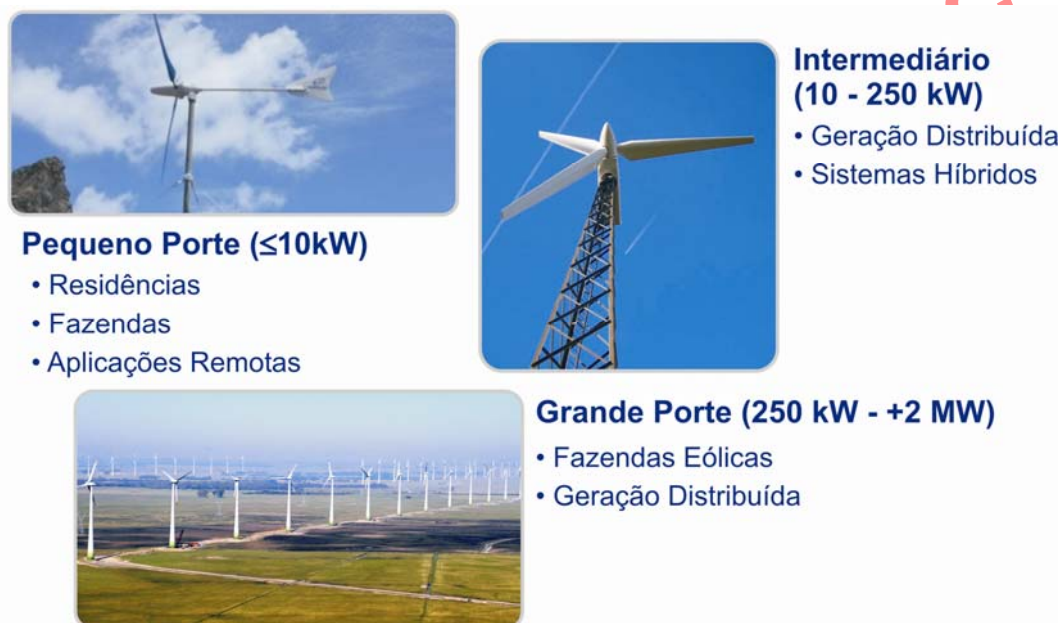
Figura 27 - Considerações sobre o tamanho das turbinas eólicas e suas principais aplicações
