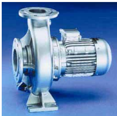
Figura 7.7 - Bomba circular para o circuito solar, encapsulamento de ferro fundido, com eixo de aço crômio-níquel e propulsor de ferro fundido ou gunmetal
