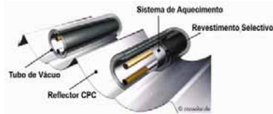
Figura 6.20 - Estrutura esquemática de um colector CPC
