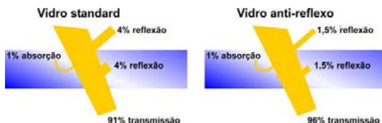
Figura 3.7 - O efeito do vidro anti-reflexo
