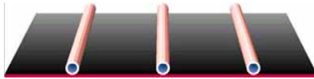
Absoror com um sistema de tubos soldados numa chapa de metal Fonte: Wagner
